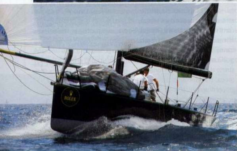
Il GP 42 Roma in navigazione con lo spi asimmetrico. Le vele sono state realizzate con la tecnologia Membrane da Paolo Semeraro.
